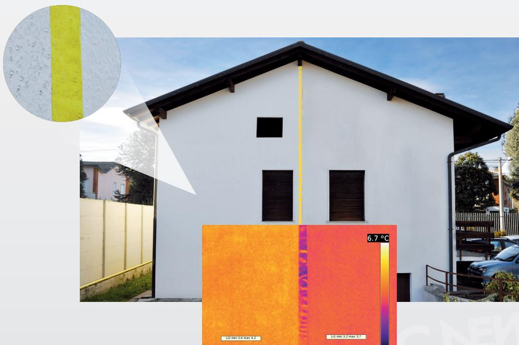
Questo permette alla superficie trattata con METASILOSSAN di mantenere una temperatura superiore (minor dispersione di calore), come evidenziato dall'analisi termografica.
